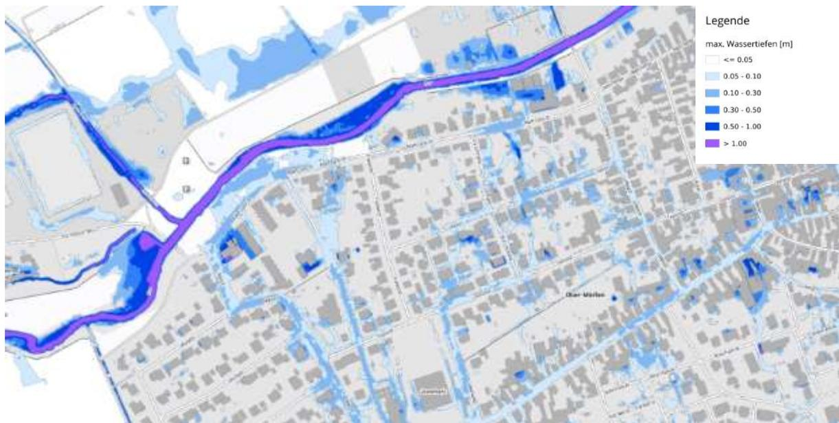
Abbildung 17: Kartenausschnitt der Ergebnisse der Starkregenergebnisse. Hier, max. auftretende Wassertiefen während der Simulation. Dabei werden Wassertiefen < 0.05 cm ausgeblendet.
