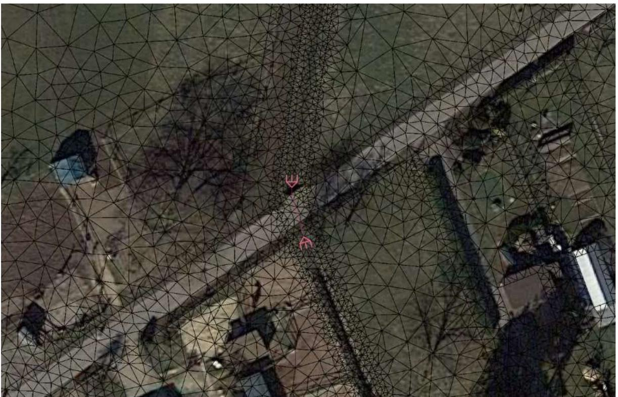
Abbildung 13: Darstellung der Vermaschung im Bereich einer Verrohrung. Die eingefärbten Kanten zeigen die Einlauf- bzw. Auslaufbruchkanten. Dies stellt sicher, dass die Netzgeometrie der Numerik gerecht wird.
