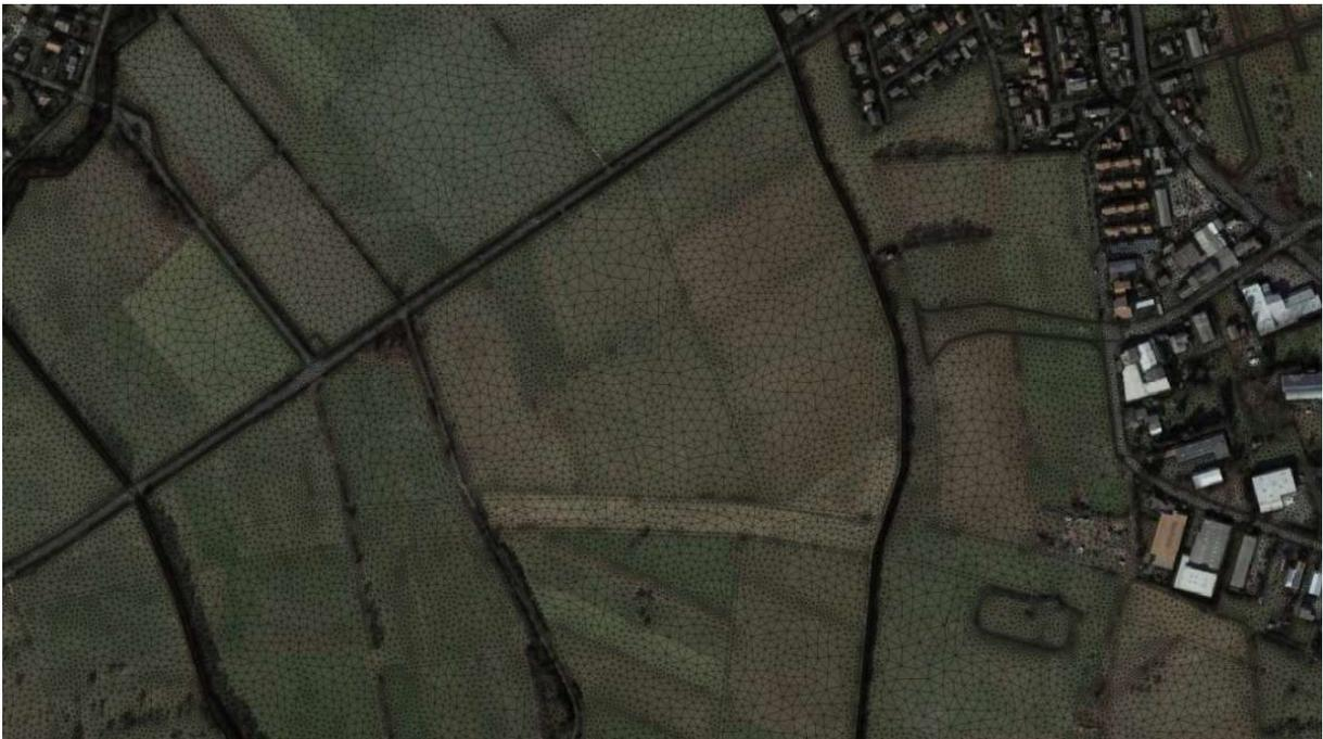
Abbildung 11: Darstellung der Vermaschung im Bereich des Außengebietes und der Gräben.
